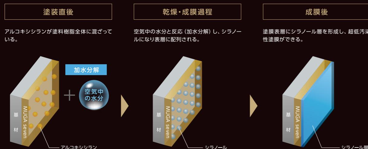
シラノールとはアルコキシランを加水分解して得られる親水性を発揮する化合物です。表層が変成したその塗膜は付着した汚染物質をハイドロクリーニング効果により雨水が流し落とします。また、静電気の帯電も少なくチリやホコリを寄せ付けず、建物の美しさを長期にわたり保ち続けます。
